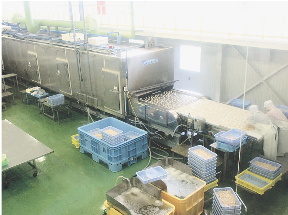
ブラインとエアブラストの長所を掛け合わせた新型ドーワコンテックフリーザーSAタイプ
